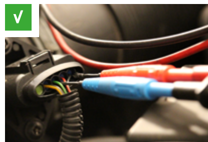
Rys. 3: Końcówki pomiarowe na tylnej stronie wtyczki
